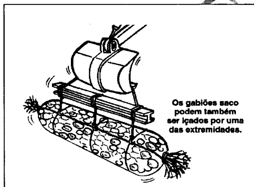
Figura 6. Içamento Gabião saco
