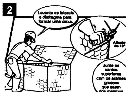
Figura 2. Posicionamento dos painéis laterais e diafragmas.
