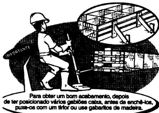
Figura 5. Detalhe da utilização do trefor ou gabarito.
