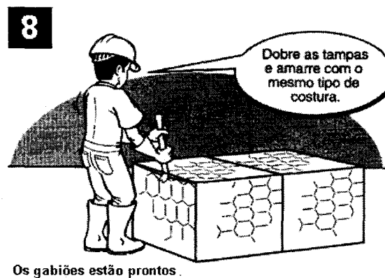
Figura 9. Detalhe da etapa de fechamento do gabião tipo caixa.
