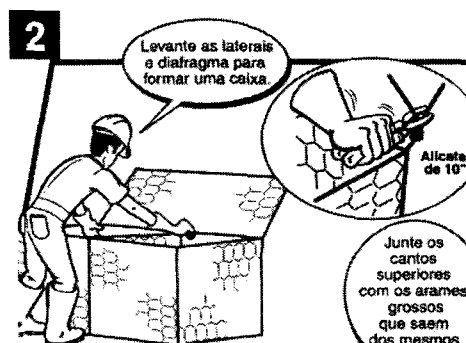
Figura 2. Posicionamento dos painéis laterais e diafragmas.
