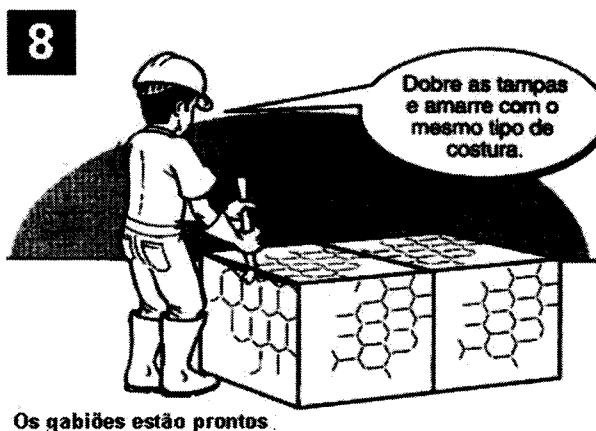
Figura 9. Detalhe da etapa de fechamento do gabião tipo caixa.
